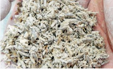
⊕ **IL CANAPULO** è la parte legnosa della pianta della canapa (*Cannabis Sativa L.*). La canapa è stata scelta 25 anni fa per il suo elevato contenuto di silice, che rende il materiale resistente al fuoco e alla decomposizione. Il canapulo possiede al suo interno migliaia di macro e micro porosità che assorbono rapidamente l'umidità e la rilasciano gradualmente, cosa che rende questo materiale un regolatore naturale dell'umidità.
